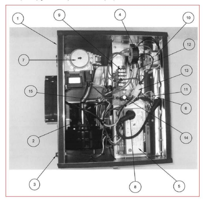
Figure 25. BURNER HEAD PARTS - DUNGS VALVE
