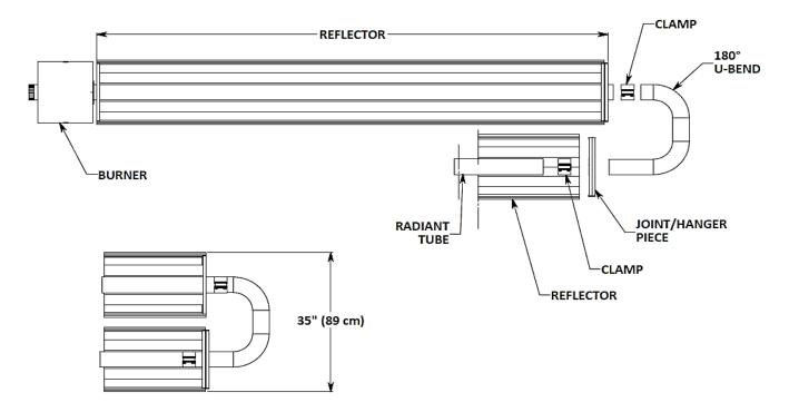
Figure 14. 180° U-BEND KIT INSTALLATION
